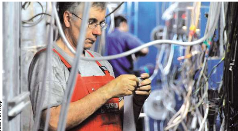
Bild 3: Bei der Zerlegung der Tiefdruckmaschinen wird jedes Einzelteil katalogisiert. Defekte Teile werden sofort ausgetauscht oder repariert.
