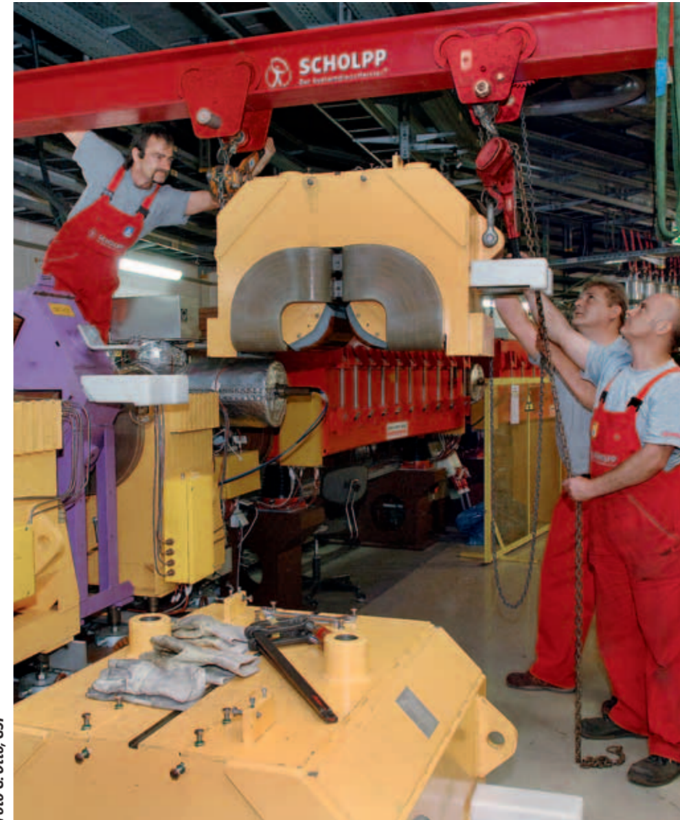
SCHOLPP mit Aluminium-Leichtbauportal bei der Arbeit an den Vakuumkammern
