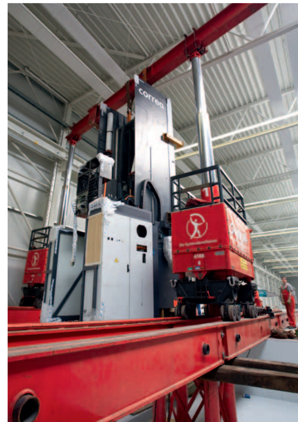
SCHOLPP-Hubgerüst TG 1000 beim Einbringen des Fahrständers einer Bettfräsmaschine unter engen Platzverhältnissen
