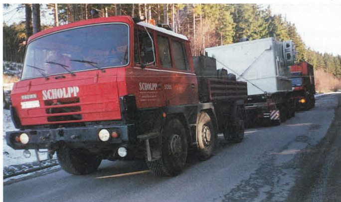
Die Tatra Zugmaschine mit luftgekühltem 360 PS Motor.
